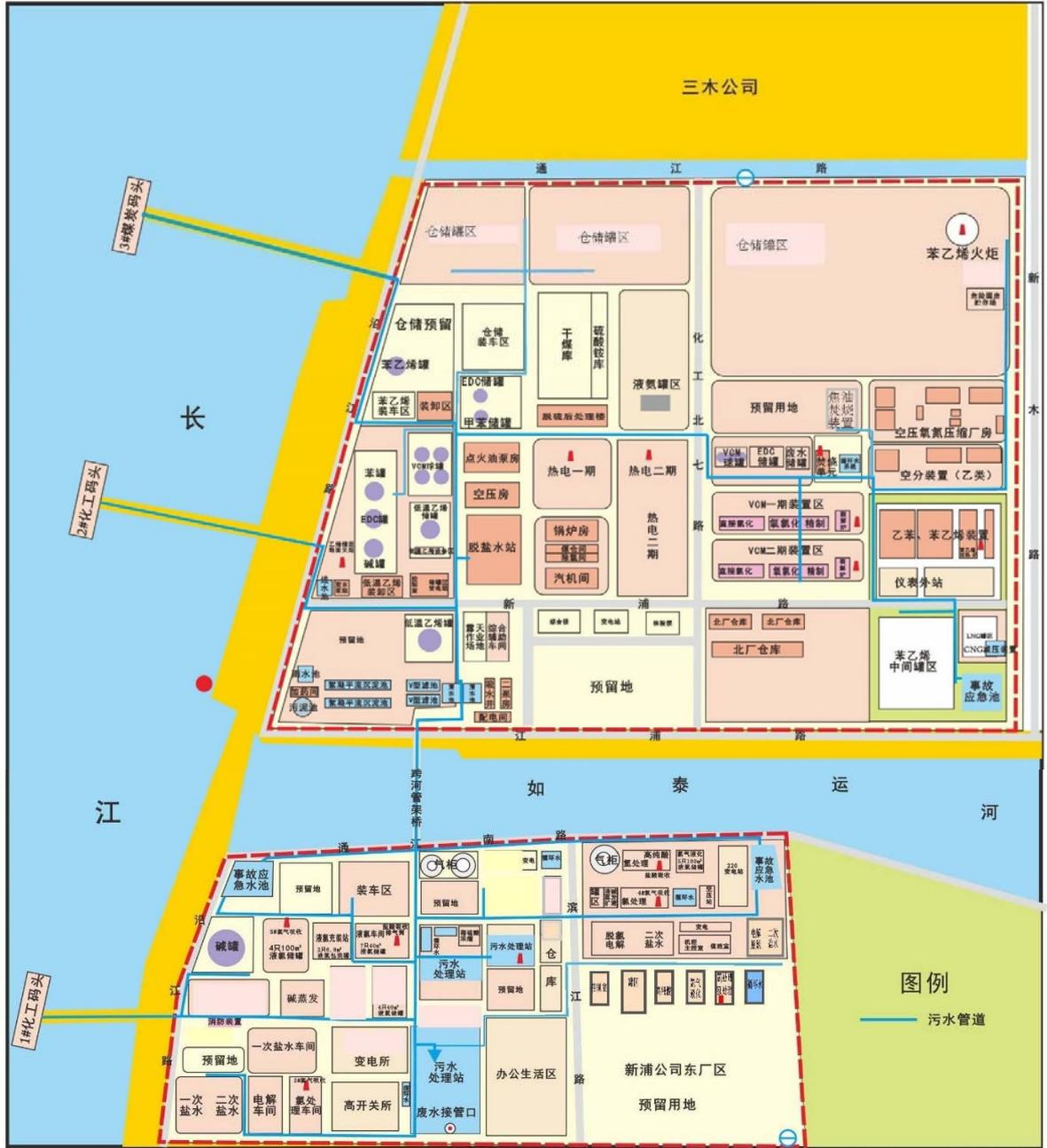
附图5 新浦化学南厂区及北厂区污水管网图
