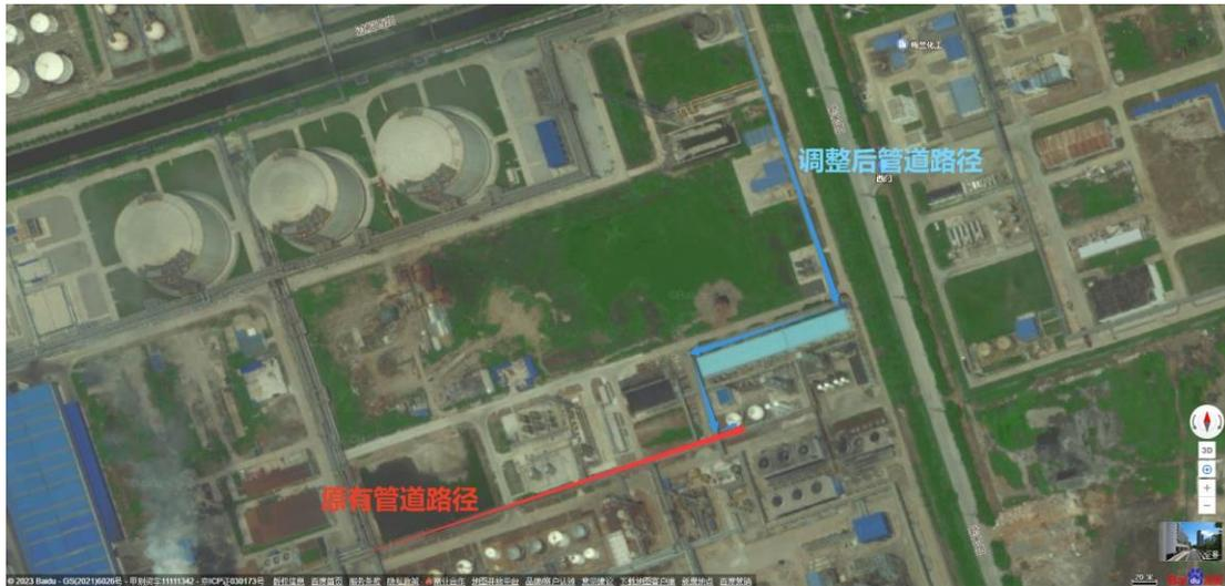
图 4-2 氮气管道（HN-00035-12"-B7A）调整示意图
