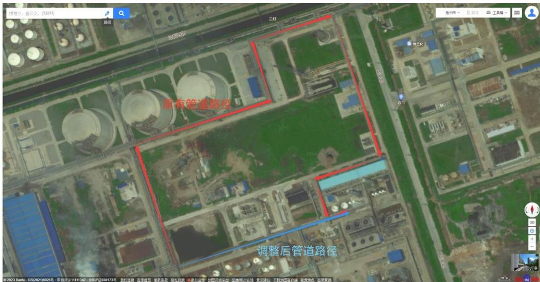
图 4-3 氧气管道（OSS-00001-6"-B1K）调整示意图
